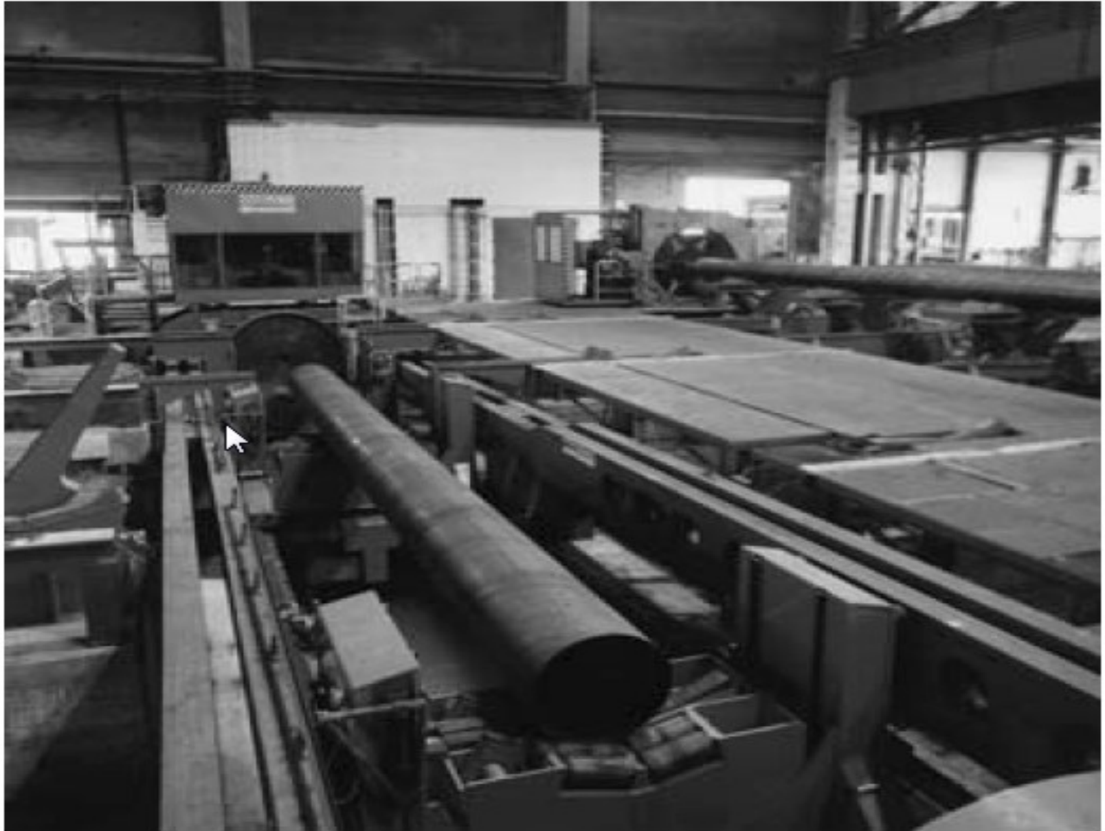
Wasserdruckprüfanlage mit nachfolgender Rohrendenbearbeitung (Werkfoto: Salzgitter Großrohre GmbH)
